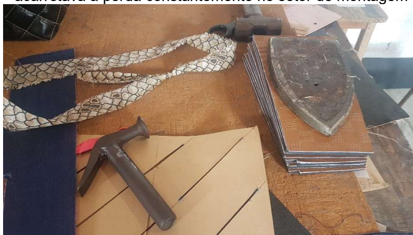
Figura 05 – Foto retirada na primeira visita: Ferramentas sem locais padronizados, o que acarretava a perda constantemente no setor de montagem
