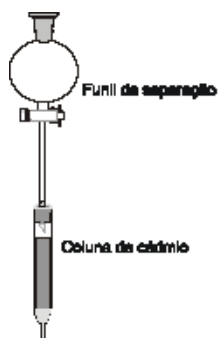
Figura 2. – Funil de separação acoplado à coluna de cádmio.
