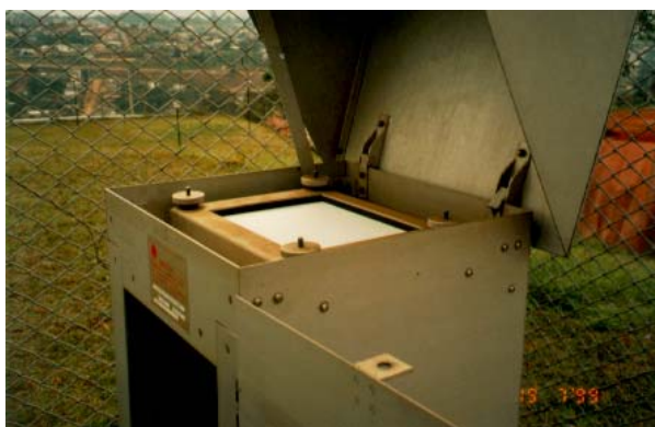
Figura 4. 21 - Detalhe do filtro de fibra de vidro (Foto: Mauricy Kawano).
