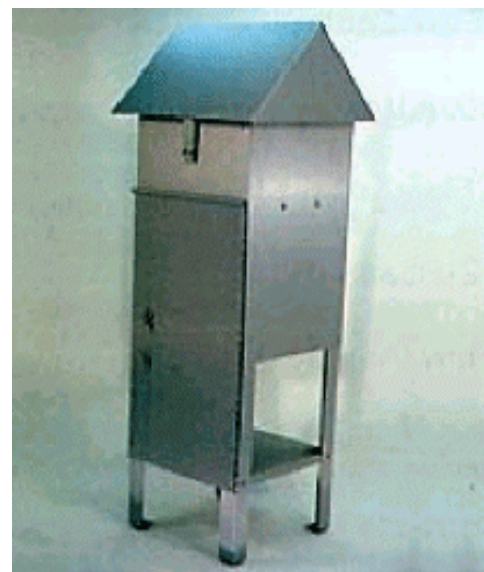
Figura 4. 20 - Amostrador ativo de grande volume ( high-vol ) utilizado para coleta da imissão de Material Particulado.
