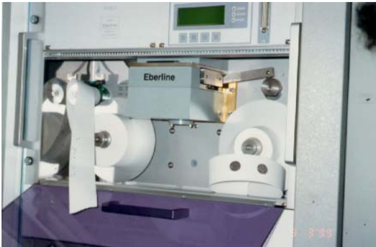
Figura 4. 38 - Analisador de material particulado
