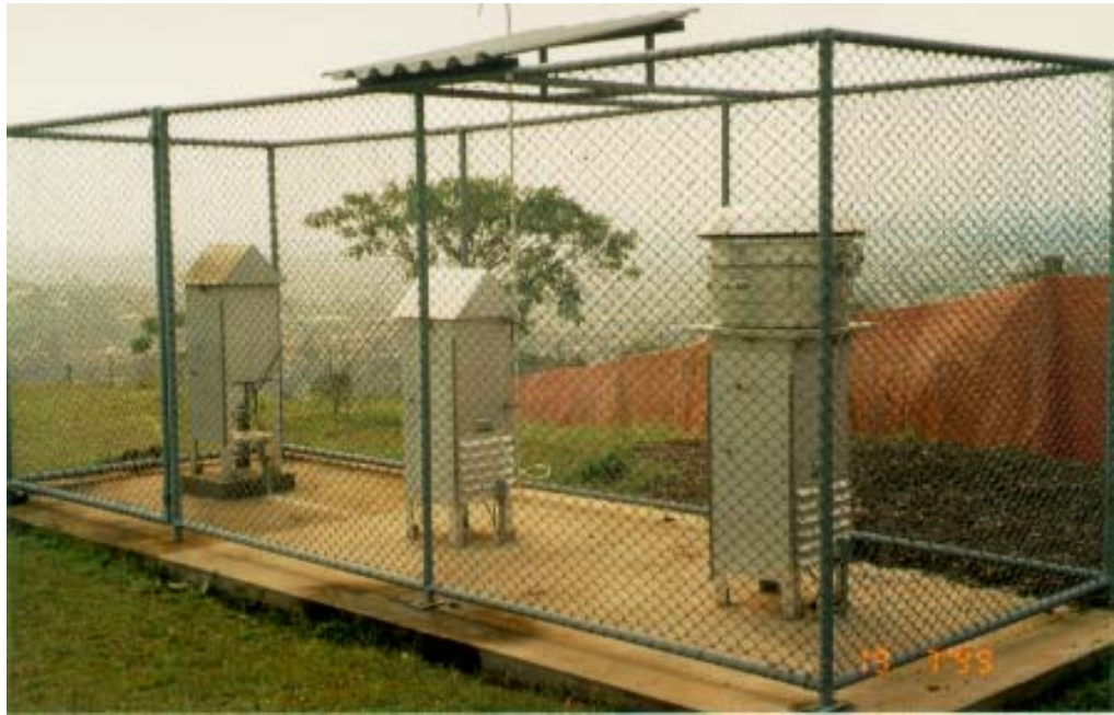
Figura 4. 22 - Estação fixa para monitoramento da qualidade do ar com equipamentos utilizados para medição de Poluentes Atmosféricos: Hi-Vol, Trigás e Hi-Vol MP10 (Klabin Telêmaco Borba – PR) - Foto: Mauricy Kawano.
