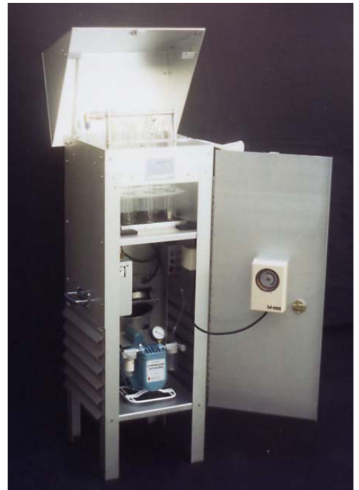
Figura 4. 32 - Trigás amostrador de pequeno volume utilizado para medição simultânea de 3 gases poluentes atmosféricos (SO 2 , NO 2 , H 2 S, NH 3 ).
