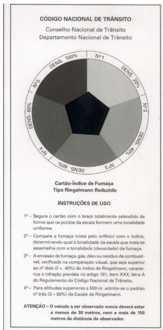
Figura 4. 27 – Escala de Ringelmann Reduzida
