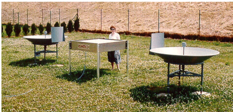
Figura 4. 51 - ANTENA DE SODAR ENTRE ANTENAS DE RASS
