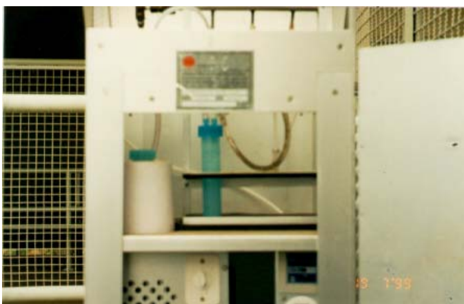
Figura 4. 30 - Trigás - detalhe ao centro em azul - borbulhador contendo solução de peróxido de hidrogênio para coleta de Dióxido de Enxofre (SO 2 )
