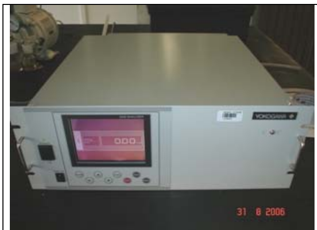
Figura 4. 55 - Analisador de CO 2 por sensor de Infravermelho.
