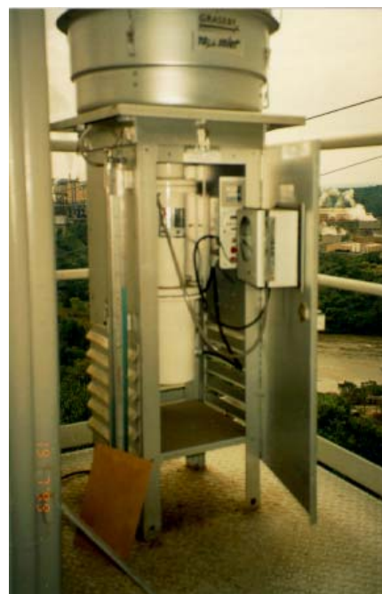
Figura 4. 24 - Hi-Vol MP10 utilizado para coleta de Material Particulado de tamanho menor que 10 µm.
