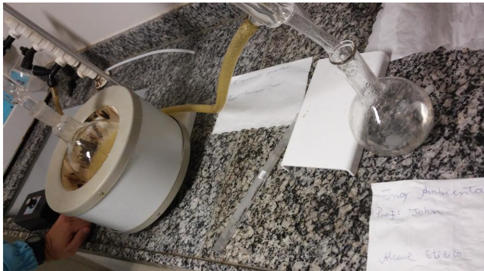
Figura 3: Processo de destilação do álcool
