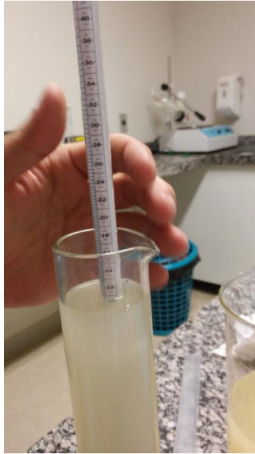
Figura 6: Medição da porcentagem do álcool produzido utilizando um decímetro na escala Gay-Lussac
